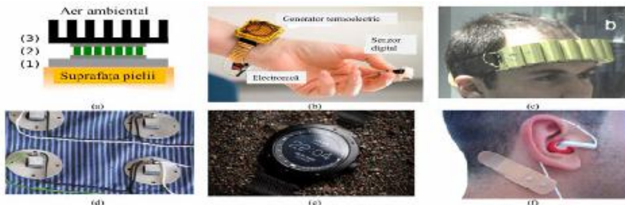
Fig. 3. Aplicații TEG verticale portabile: (a) ilustrație schematică a unui modul TEG alimentat de căldură corporală cu (1) interfață termică între partea caldă a pielii / TEG, (2) modul TEG și (3) radiator care asigură disiparea căldurii către aerul înconjurător (Thielen et al. , 2017), (b) Oximetru de puls portabil bazat pe TEG bazat pe CMOS cu poli-SiGe TC (Leonov et al. , 2009), (c) bandă cu electroencefalografie (EEG) (Leonov et al. , 2009), (d) câșmă de electrocardiografie (ECG) (Leonov, 2013), (e) ceas de putere matricial alimentat cu TEG și căldură corporală (Boukai, 2017) și (f) aparat auditiv biomedical (Lay-Ekuakille et al. , 2009).
