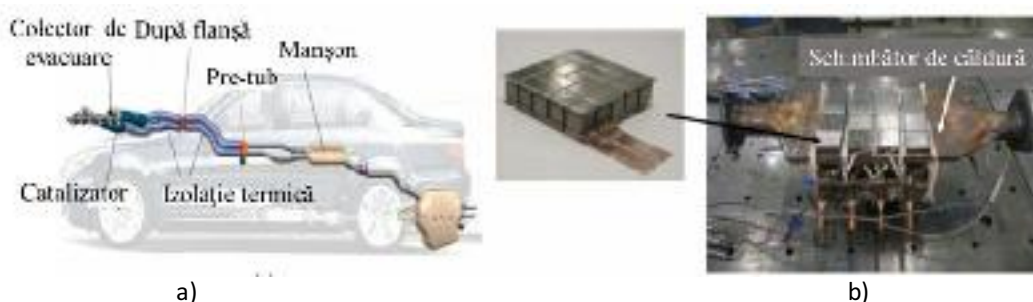
Fig. 5. Pozițiile generatorului termoelectric: (a) Sistem de evacuare în interiorul unui vehicul de pasageri (Crane și LaGrandeur, 2010). (b) Ansamblul TEG pe un schimbător de căldură plat (Mori et al., 2011).
