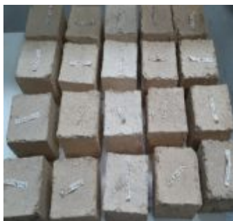
Fig. 5. Probe A-V-C. 150 x 150 x 150 (mm). Condiționare: uscarea în laborator.
