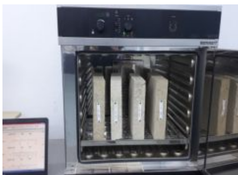
Fig. 2. Probe A-V-C. Uscare la masa constantă în etuvă la (80\pm 5)^{\circ}\text{C} .
