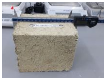
Fig. 6. Probe A-V-R. 150x 150 x 150 (mm). Măsurare dimensiuni cu șubler digital.
