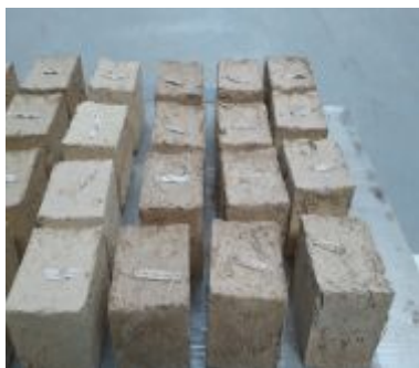
Fig. 4. Probe A-V-P. 150 x 150 x 150 (mm). Condiționare: uscarea în laborator.
